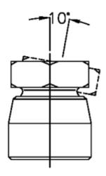
d1 = 16 d2 = M8 l1 = 19 l2 = 7 NV = 13 Static load (N) = 5000 t min = 9
